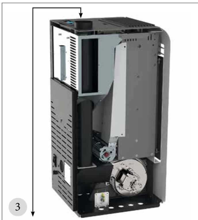
Rompe il pre-tranciato del top e collegare il tubo verticalmente uscendo nella parte superiore della stufa. È fondamentale che il tubo non entri in contatto con le parti del serbatoio e garantire il passaggio d'aria tra serbatoio e tubo.
