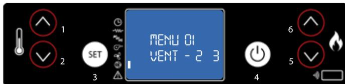
2. Premendo nuovamente il tasto SET si accede al menù per impostare la velocità del ventilatore della canalizzazione.
