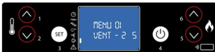
3. Impostare la velocità tramite il tasto 1. Con il tasto 1 si imposta la velocità del ventilatore
